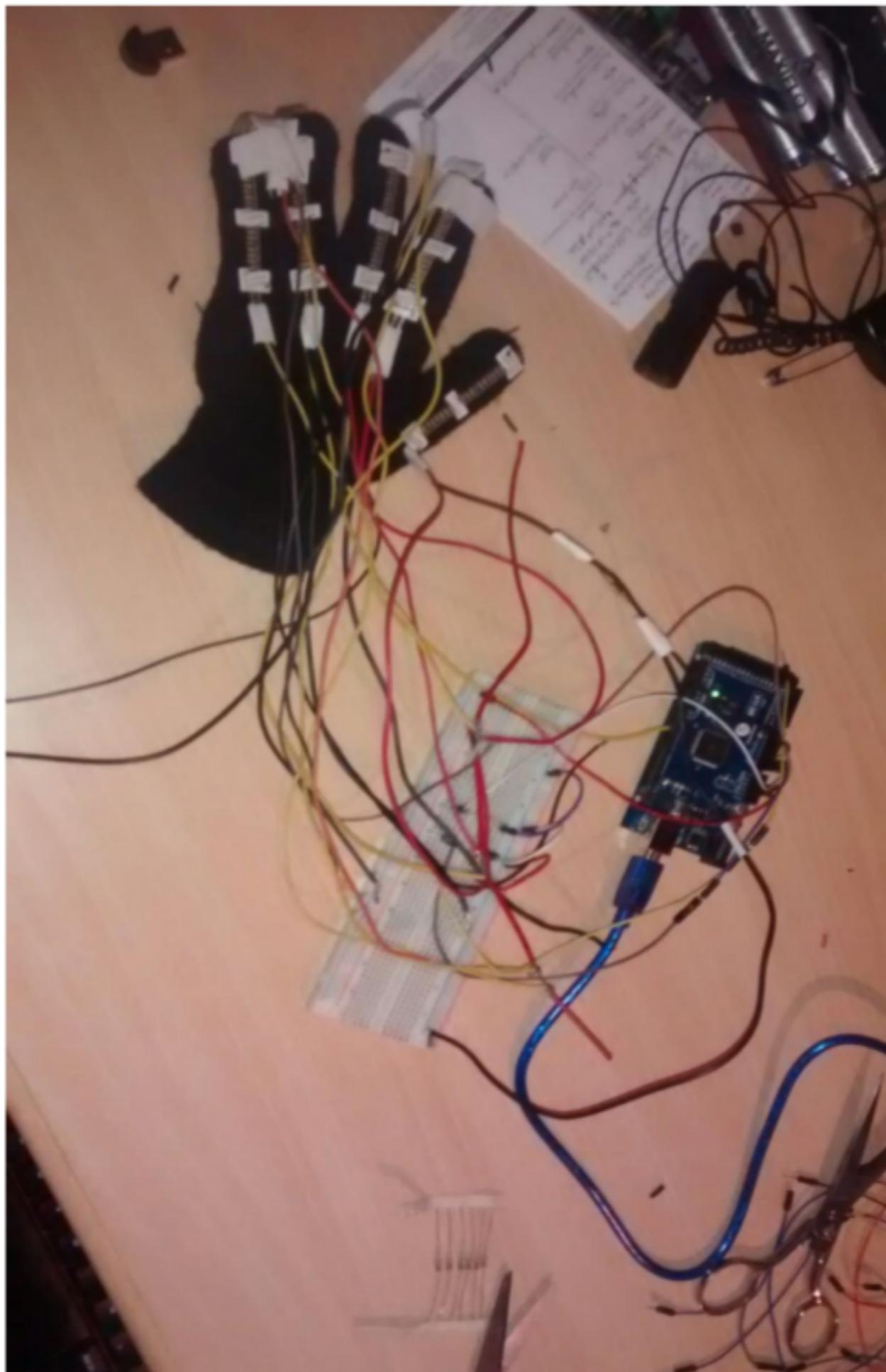
Posteriormente, siguiendo el esquema de conexión, de uno de los cables practicamos una incisión por el que soldar la resistencia y de ahí el cable que iría conectado al arduino.
