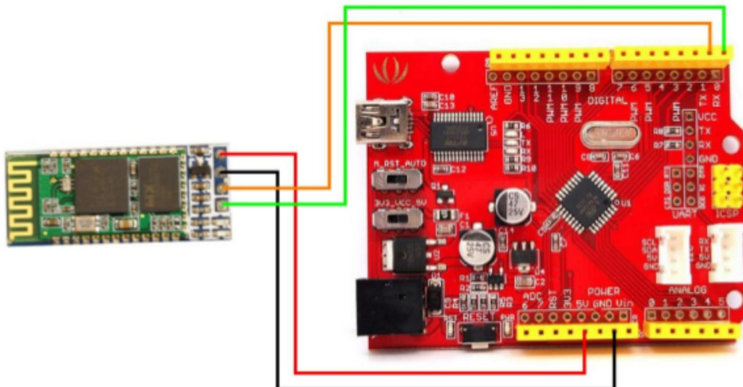
Especial atención a que los pines TXD y RXD del dispositivo no tienen que ir al TX ni RX de la arduino, aunque en el esquema anterior está así establecido. Sino que deben ir a otros pines analógicos ya que esos del arduino están reservados para la comunicación con el ordenador.
