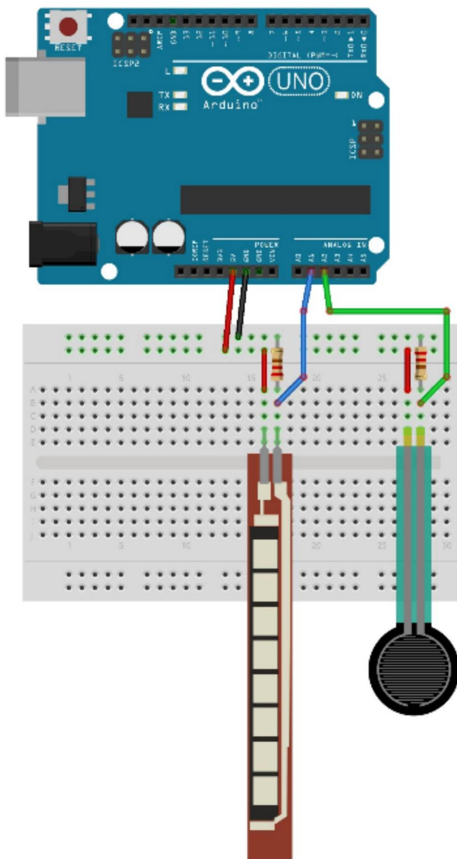
Ambos sensores disponen de una conexión a 5V mientras que en el otro tienen una conexión a masa con una resistencia de unos 10K. Algunos sitios comentan 22K o 30K. La influencia de la resistencia viene dada por el divisor de tensión.
