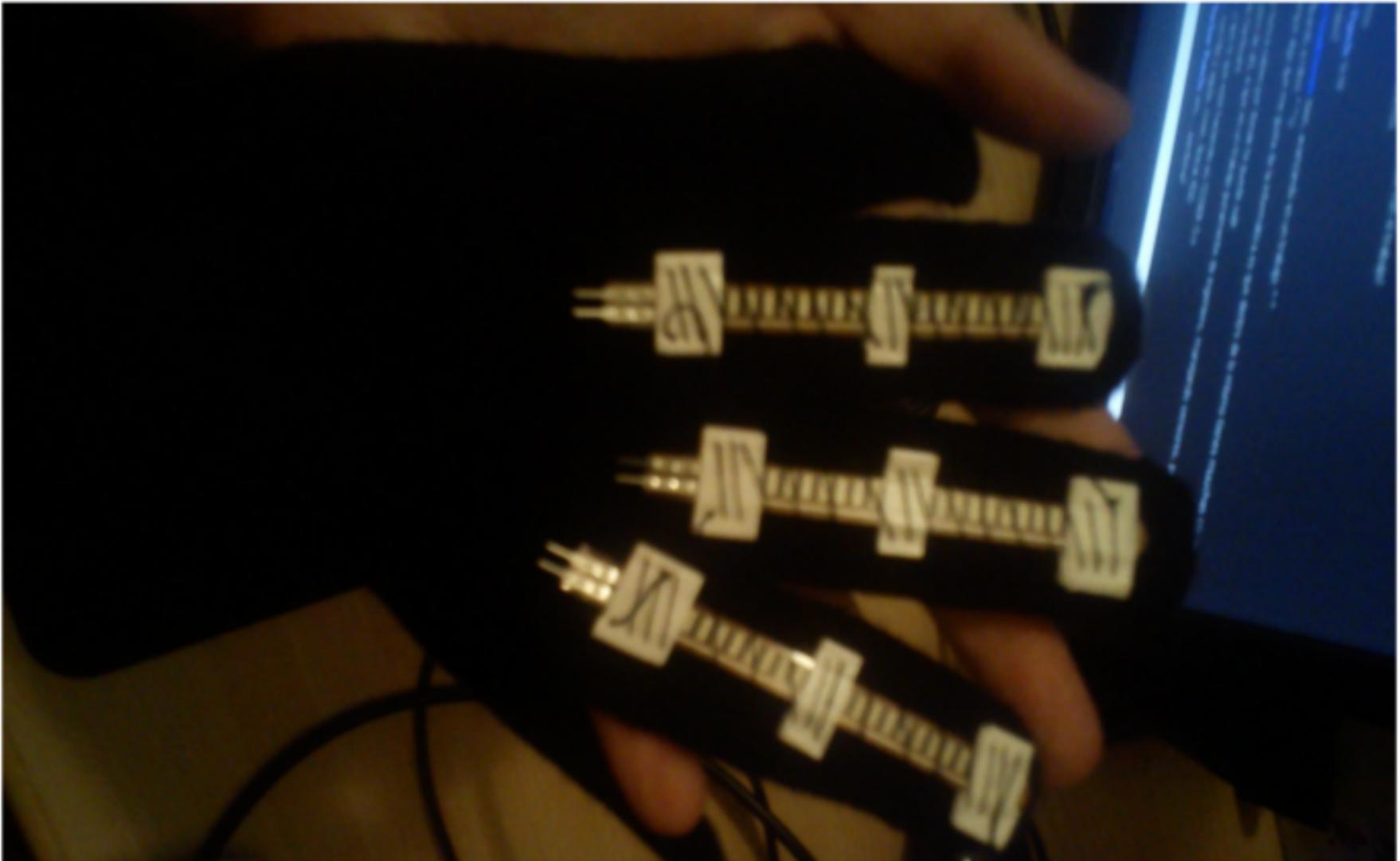
La fase de soldar fue con diferencia la más larga y trabajosa del proyecto. Al principio, con nuestra inexperiencia y miedo de estropear los sensores con el calor, soldamos con el estaño y con cuidado los extremos de los sensores con cables reciclados de una fuente de alimentación, teniendo buenos resultados.
