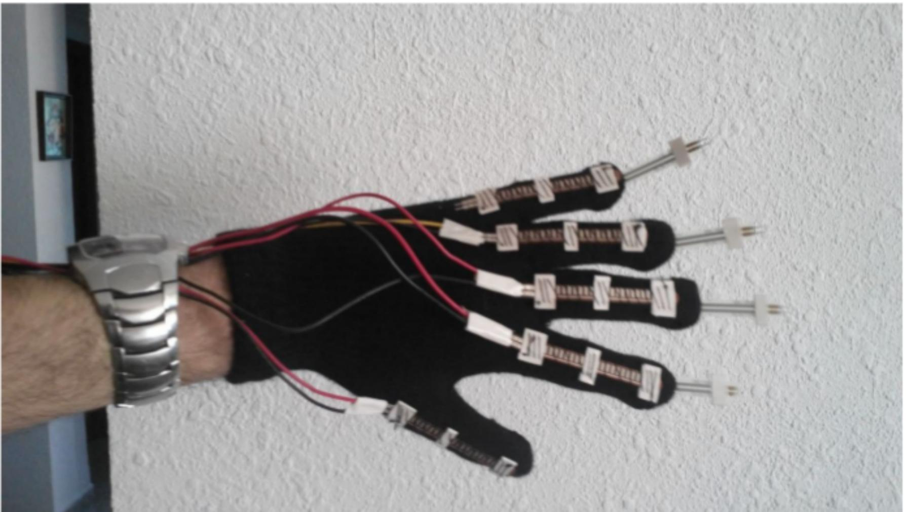
Inicialmente soldamos a todos los sensores un cable por cada extremo y los probamos para comprobar que seguían funcionando.
